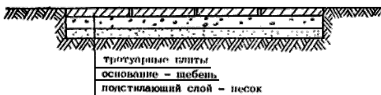
Рис.5. Конструкция тротуара с покрытием из бетонных плит
